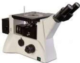
МИКРОМЕД МЕТ-3 предназначен для визуального наблюдения микроструктуры металлов, сплавов и других непрозрачных объектов в отраженном свете при прямом освещении в светлом и темном поле, а также для исследования объектов в поляризованном свете.
