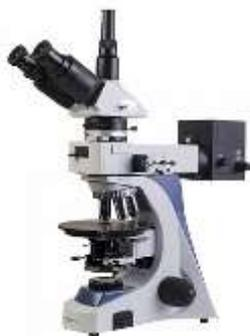
Поляризационный микроскоп МИКРОМЕД ПОЛАР 3 предназначен для исследований прозрачных микрообъектов в проходящем свете - поляризованном и обыкновенном, непрозрачных объектов - в отраженном свете - поляризованном и обыкновенном.
