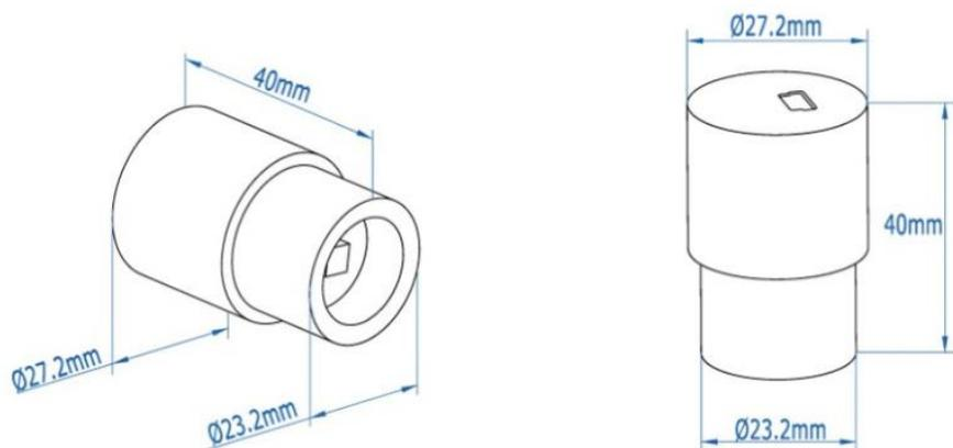
Для установки в тубусы микроскопа другого диаметра можно использовать переходные кольца
