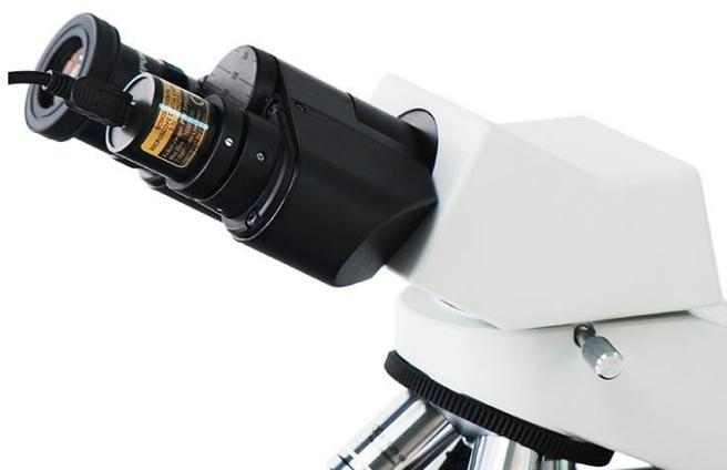
Установка камеры в тринокулярный микроскоп
