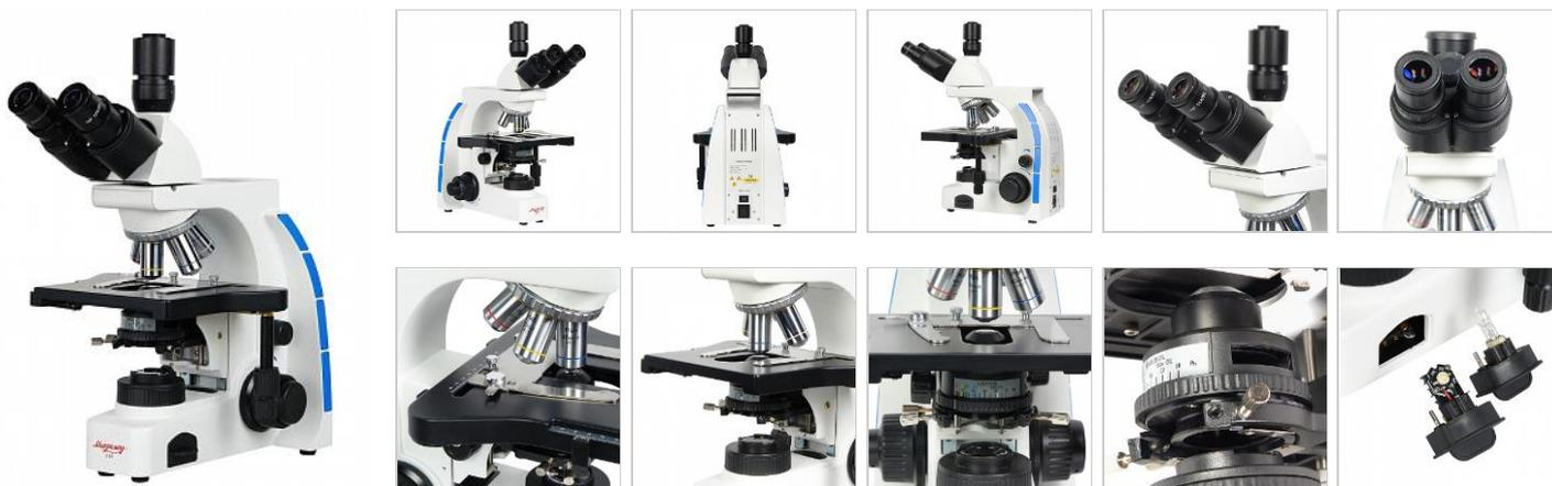
Тринокулярный микроскоп **Микромед 3** предназначен для наблюдения и морфологических исследований препаратов в проходящем свете по методу светлого поля, а также по методу темного поля, фазового контраста и в поляризованном свете в комплекте с соответствующими устройствами, поставляемыми по дополнительному заказу.
