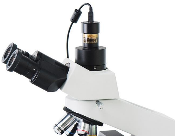
Установка камеры в тринокулярный микроскоп
