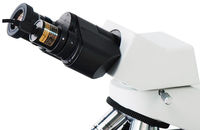
Установка камеры в тринокулярный микроскоп
